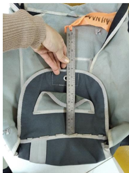
ранец «старого кроя» высота клапана 200 \pm 5 мм
