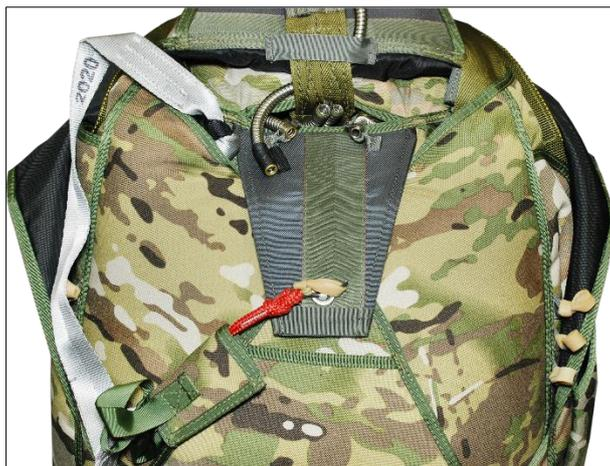
Рисунок 120 – Зачековка клапанов контейнера ОП
