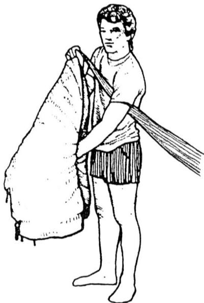
Рисунок 100 – Скручивание задней кромки купола
