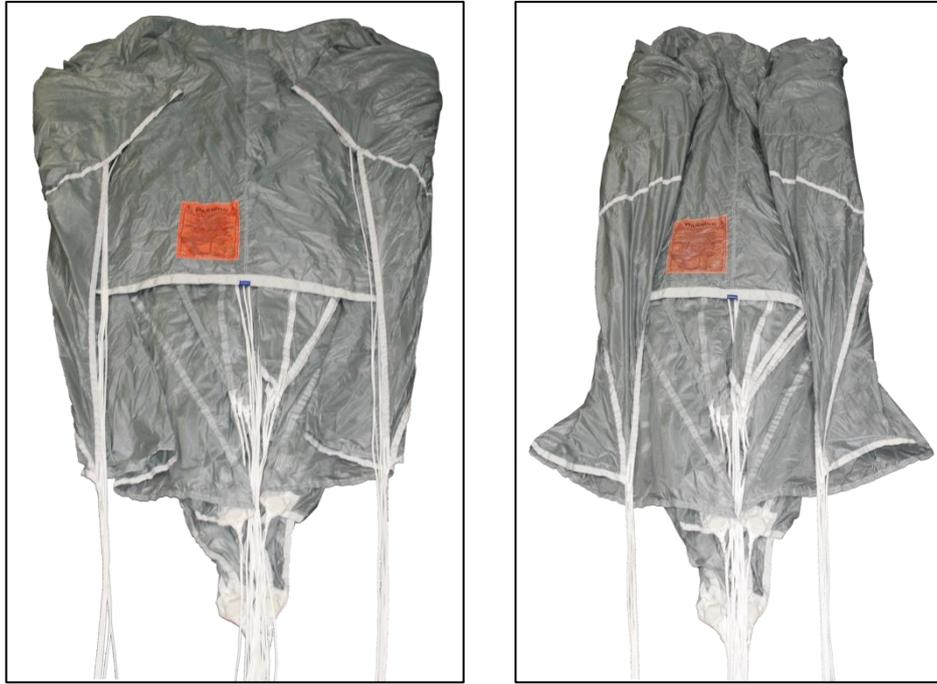
Рисунок 111 – Сворачивание левой и правой задней кромки купола
