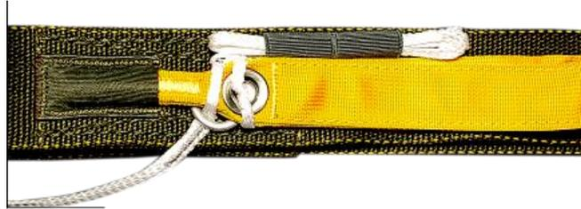
Рисунок 38 – Заправка удлинителя СУ
