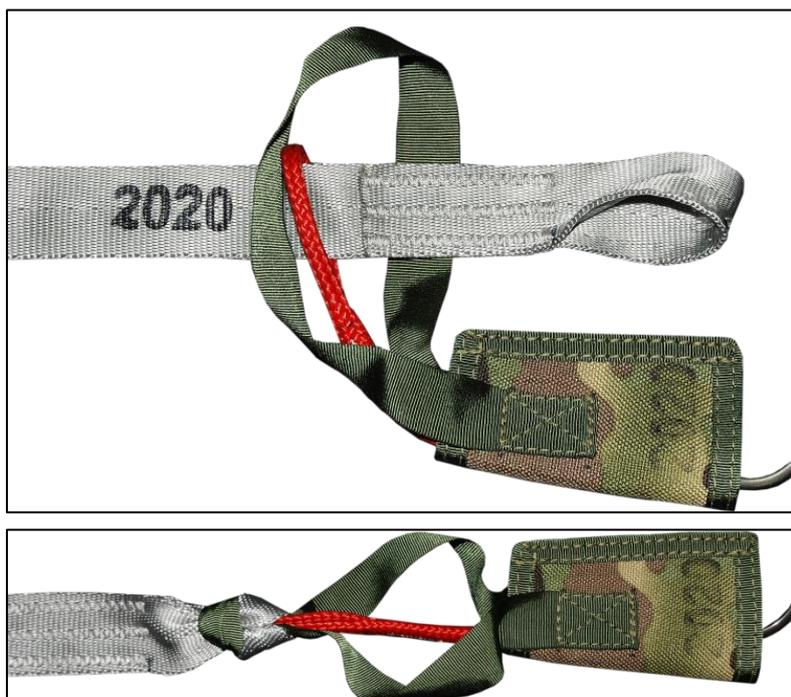
Рисунок 154 – Монтаж звена расчеховки
