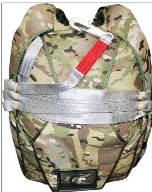
Рисунок 123 – Укладка вытяжного звена
