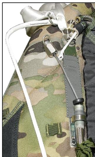
Рисунок 146 – Монтаж ППК-У в карман прибора
