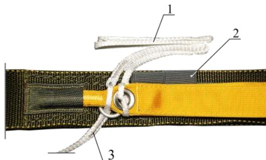
Рисунок 37 – Выполнение зигзагообразного сложения удлинителя СУ
