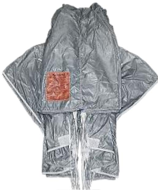
Рисунок 71 – Укладка хвостовой части купола
