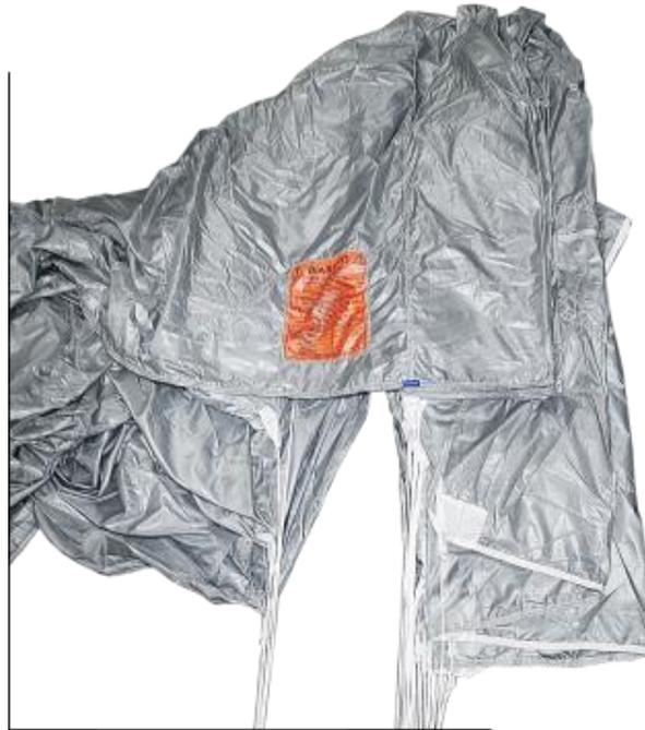
Рисунок 67 – Укладка задней кромки купола
