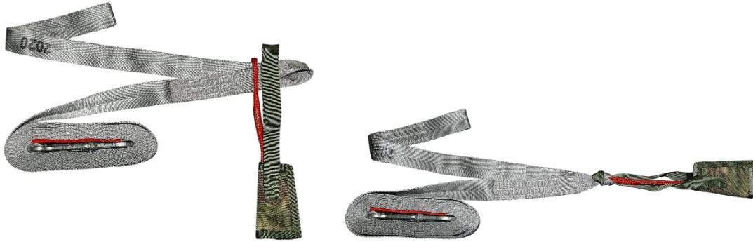
Рисунок 95 – Монтаж звена расчеховки и чехла ко второй петле вытяжного звена
