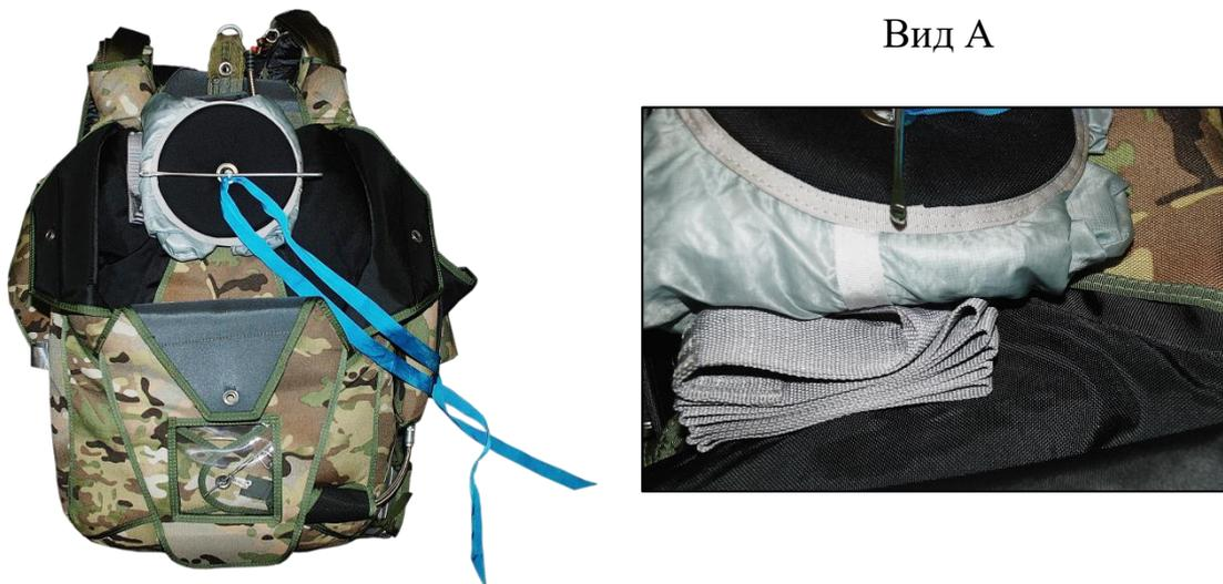
Рисунок 157 – Укладка соединительного звена
