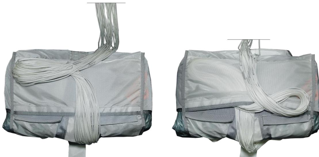
Рисунок 80 – Укладка строп в карман камеры
