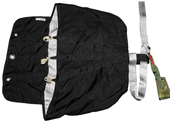
Рисунок 96 – Монтаж петли камеры к первой петле вытяжного звена
