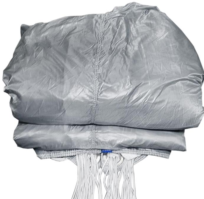
Рисунок 77 – Подготовка купола к укладке в камеру
