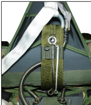
Рисунок 139 – Зачековка шпилькой звена раскрытия КЗУ
