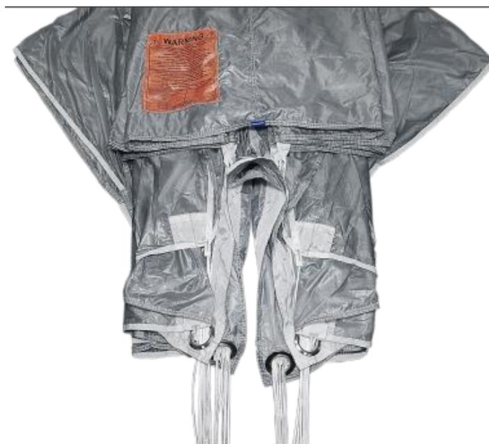
Рисунок 73 – Размещение слайдера между уложенными полотнищами
