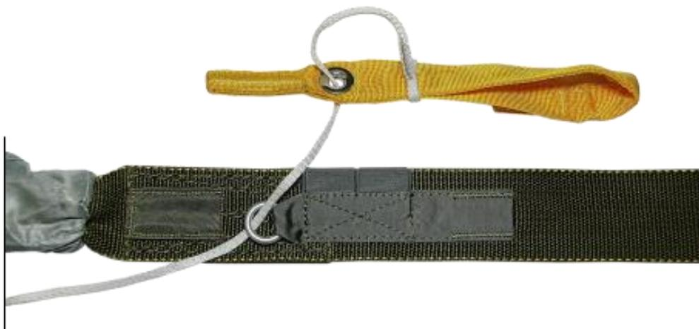
Рисунок 33 – Монтаж удлинителя СУ на звено управления
