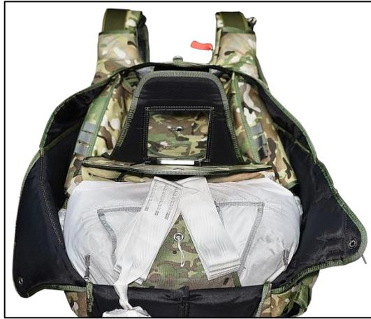
Рисунок 84 – Укладка звена камеры
