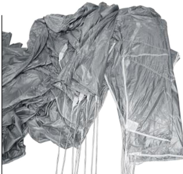
Рисунок 65 – Укладка полотнищ между стропами 3 и 4 ряда
