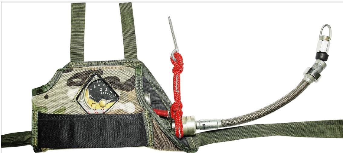
Рисунок 170 – Монтаж звена расчековки на прибор ППК-У
