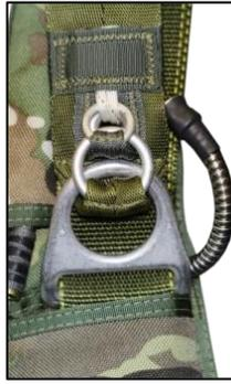
Рисунок 92 – Проверка монтажа СК к подвесной системе
