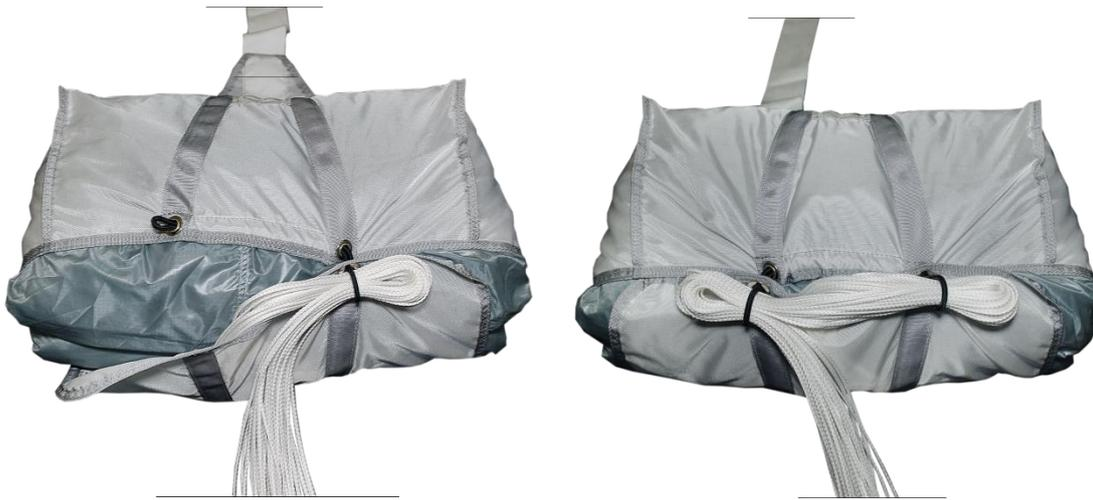
Рисунок 79 – Зачековка камеры
