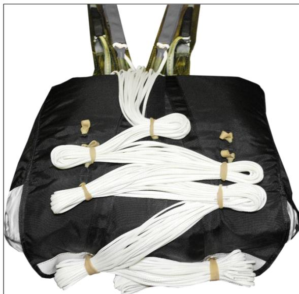
Рисунок 117 – Укладка строп в соты камеры
