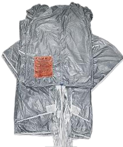
Рисунок 70 – Укладка задней (правой) кромки купола
