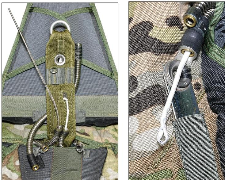
Рисунок 127 – Расположение троса звена раскрытия и звена серьги на звене КЗУ СП
