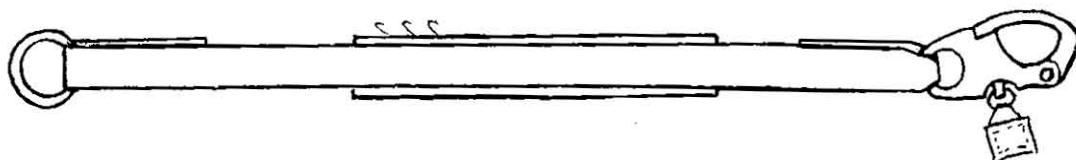
Рис. 13. Звено раскрытия («Транзит»).
