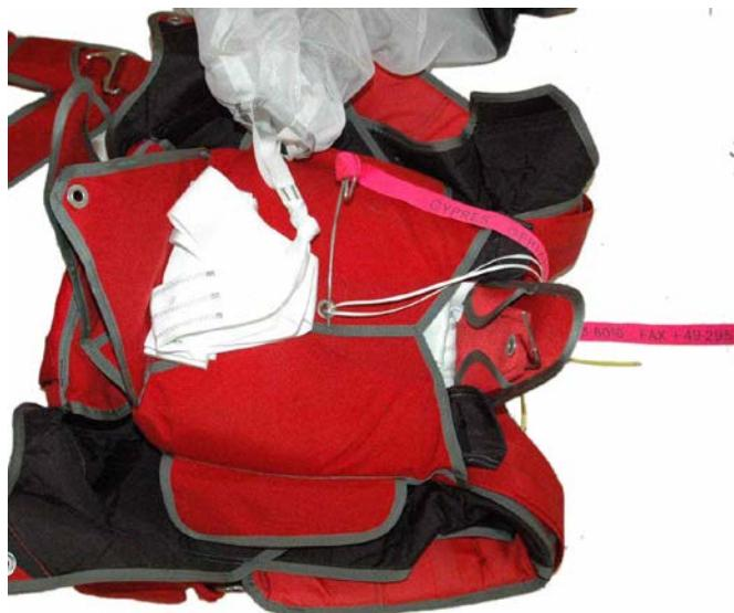
Рис. 37. Укладка звена вытяжного парашюта.
