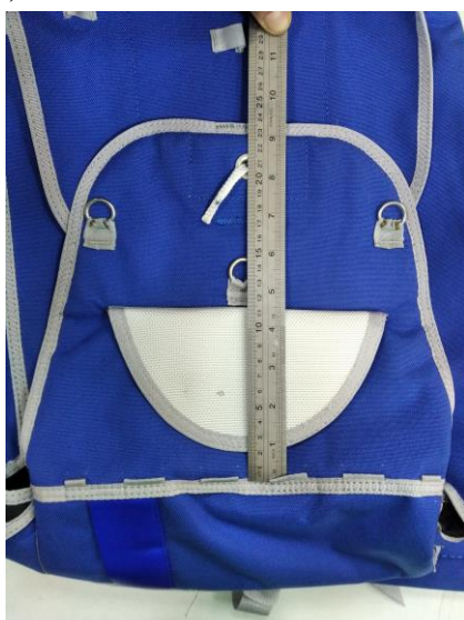
ранец «нового кроя» высота клапана 240 \pm 5 мм
