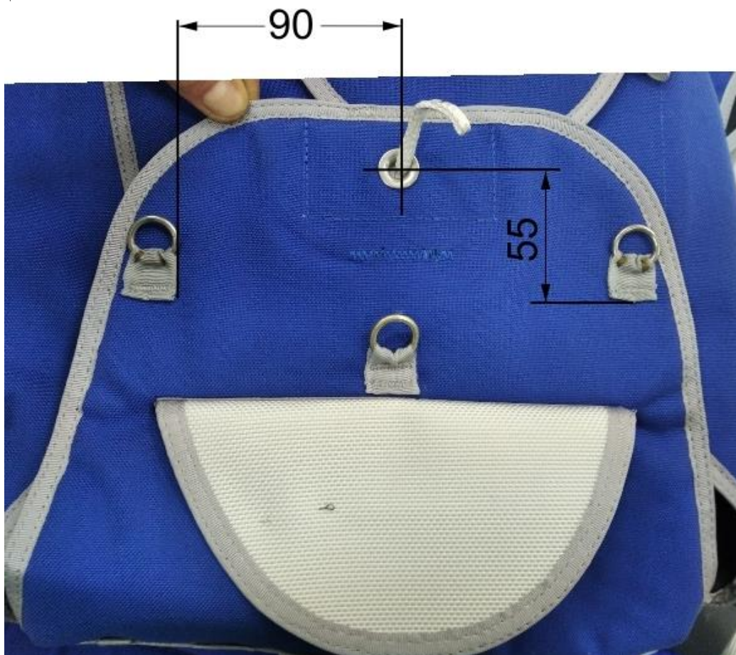
Рисунок 7 - Пришивки петель с кольцами на нижний клапан ранца «старого края»
