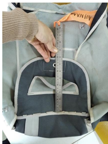
ранец «старого кроя» высота клапана 200 \pm 5 мм
