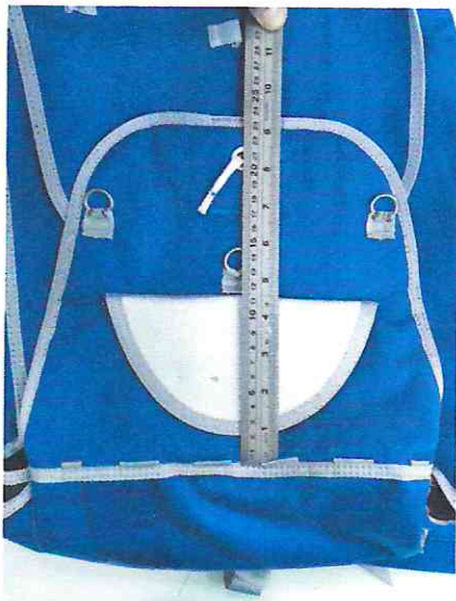
ранец «нового кроя» высота клапана 240 \pm 5 мм
