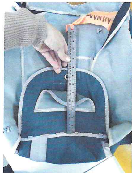
ранец «старого кроя» высота клапана 200 \pm 5 мм
